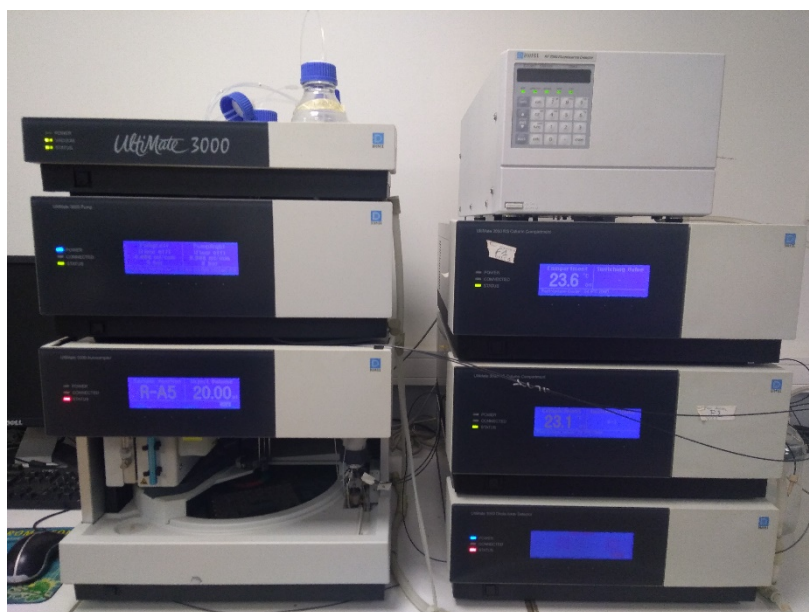
Figure 55 : Photographie du système UHPLC ThermoScientific Ultimate 3000
