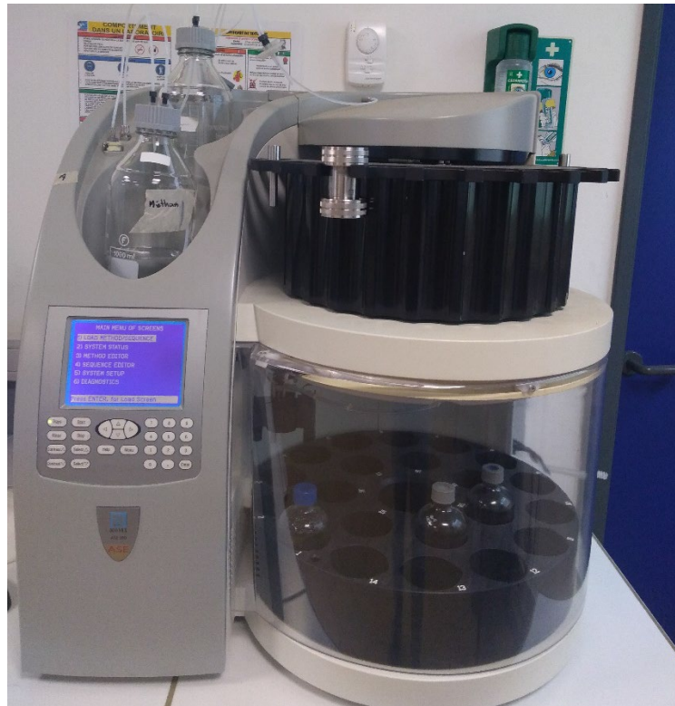
Figure 49 : Photographie d'un extracteur ASE ou extracteur solide-liquide sous pression
