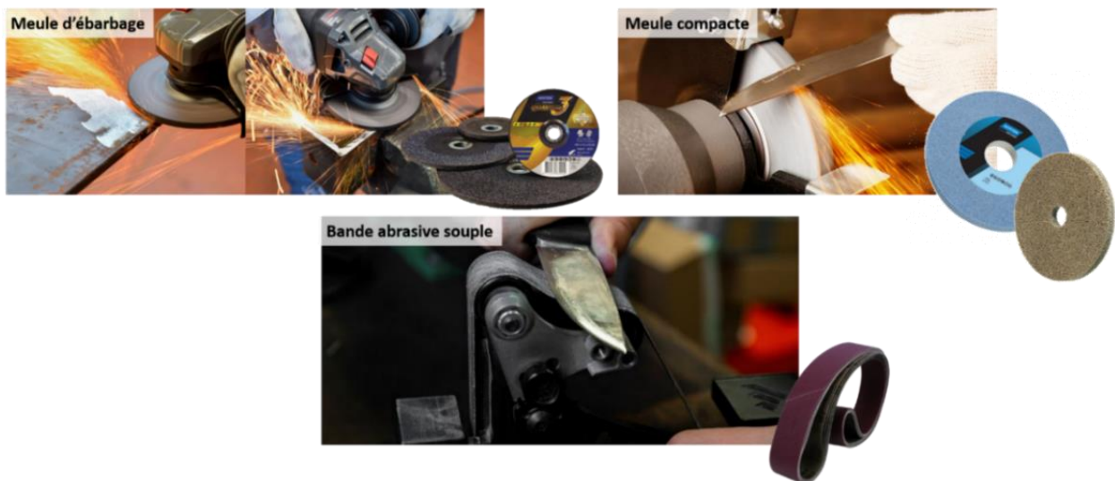
Figure 2.3-Outils abrasifs et leur utilisation (source Norton, 3M, VSM).
