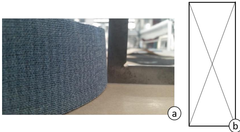
Figure 1.8-(a) Défaut de coupe non verticale dû au fléchissement de la lame ; (b) Flexion 3D de la lame (Cosson-Coche 2017).
