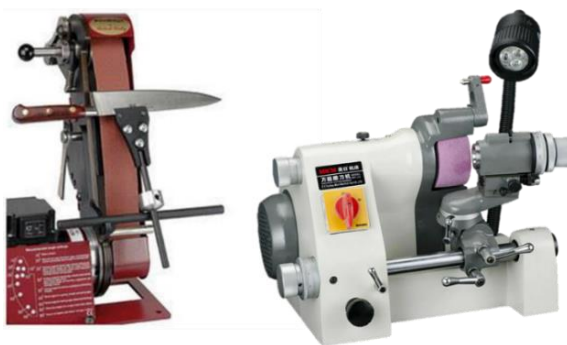
Figure 2.1- Machines universelles d'affûtage pour des outils de coupe.
