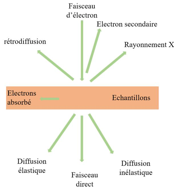
**Figure 24 : Signaux courants générés par l'interaction d'un faisceau d'électrons avec et un échantillon fin**
