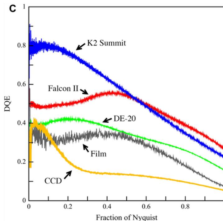
**Figure 23 DQE à 300 kV en fonction de la fréquence spatiale**
