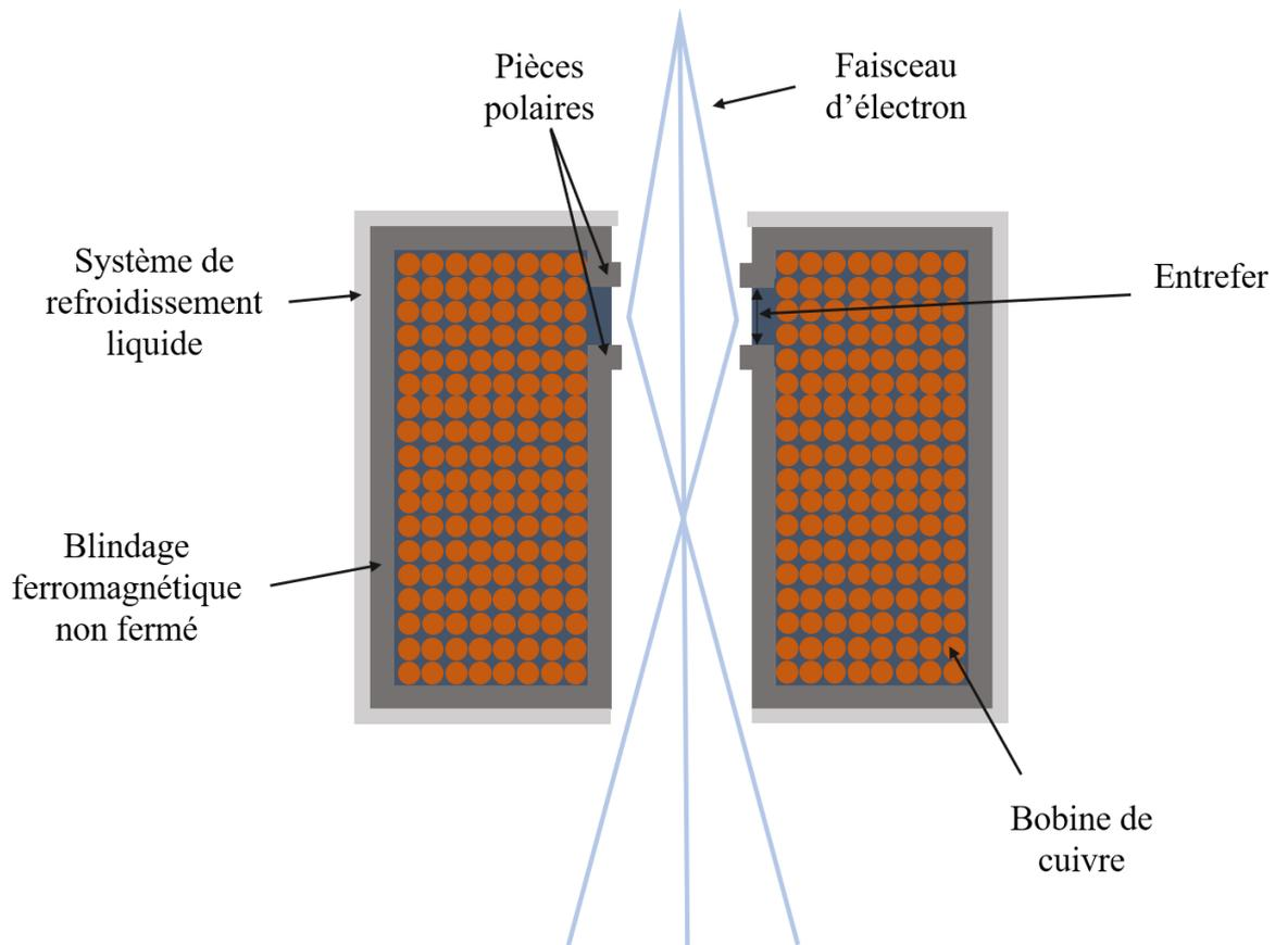
**Figure 20 : Schéma d'une lentille magnétique**
