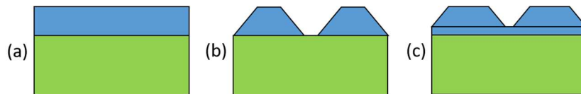
Figure 2-11 : Différents modes de croissance d'hétérostructures (a) Franck van der Merwe, (b) Volmer-Weber et (c) Stranski-Krastanow.
