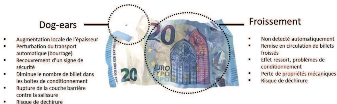
Figure 1: Problèmes liés au dog-ears et au froissement des billets de banque
