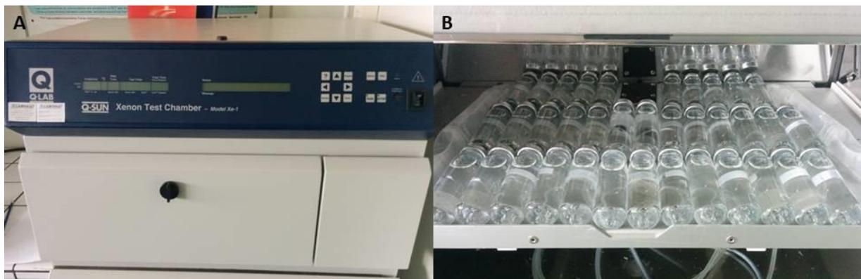
**Figure 83 : (A) Enceinte de vieillissement à arc au xénon Q-SUN Xe-1 ; (B) positionnement des échantillons à l'intérieur de l'enceinte**
