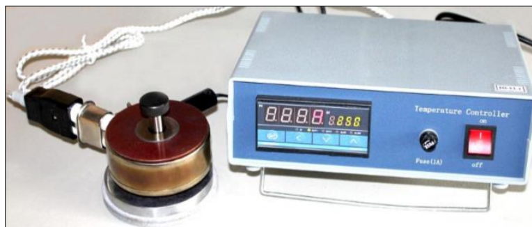
Figure 76 : Moule chauffant utilisé pour l'assemblage de batterie auto-supportée.
