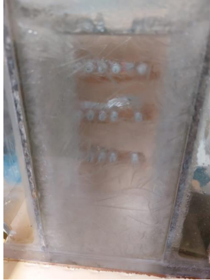
Figure 6 Vue de face montrant l'initiation de la solidification due à l'échange de chaleur avec l'extérieur
