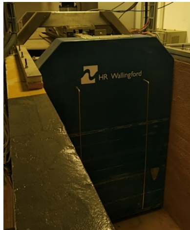
FIGURE 4.2 – Photo du batteur à vagues.
