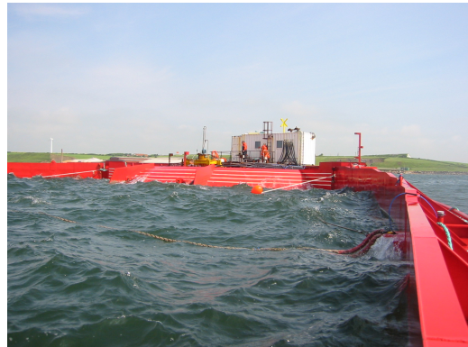
(b) Photo du prototype de WaveDragon à l'échelle 1/4,5
