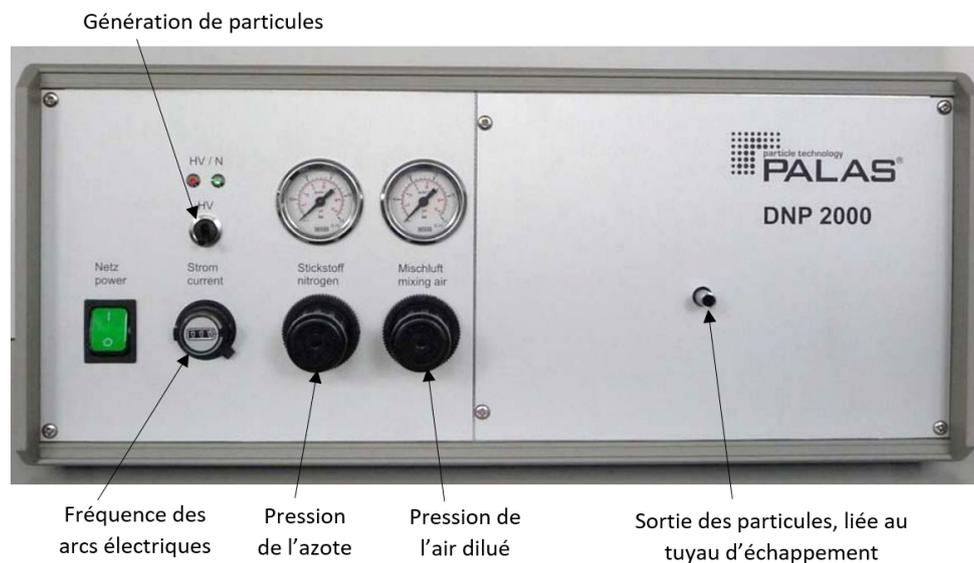
Figure 4.5 – Photo du générateur PALAS.
