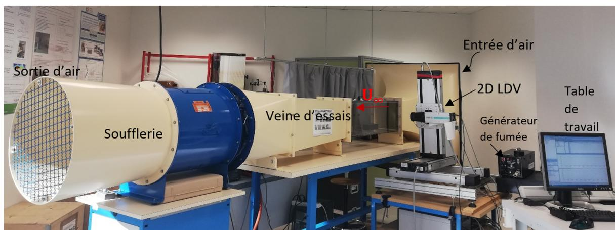
**Figure 3.6** – Dispositif expérimental pour la caractérisation de l'écoulement monophasique.
