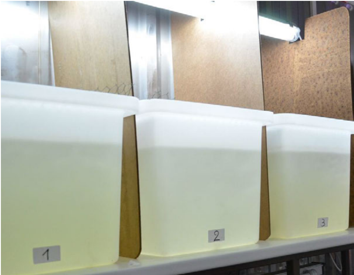
Figure 32 : Photographie des tanks expérimentaux utilisés dans l'étude n°2. Chaque tank, contenant 6 truites arc-en-ciel, est rempli d'eau minérale (Volvic®) continuellement filtrée et oxygénée. (Photo Cyril Delfosse, ©IRSEA).
