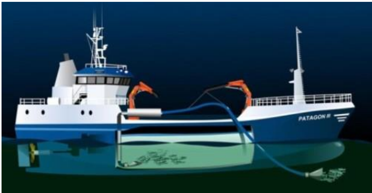
Figure 15 : Schéma d'un well-boat , un bateau spécialisé dans le transport de poisson. Le bateau est équipé d'un bassin pour maintenir les poissons et d'un tuyau aspirant pour les capturés dans leur bassin d'élevage (Crédit photo : http://www.marineinsight.com/types-of-ships/what-are-wellboats/ ).
