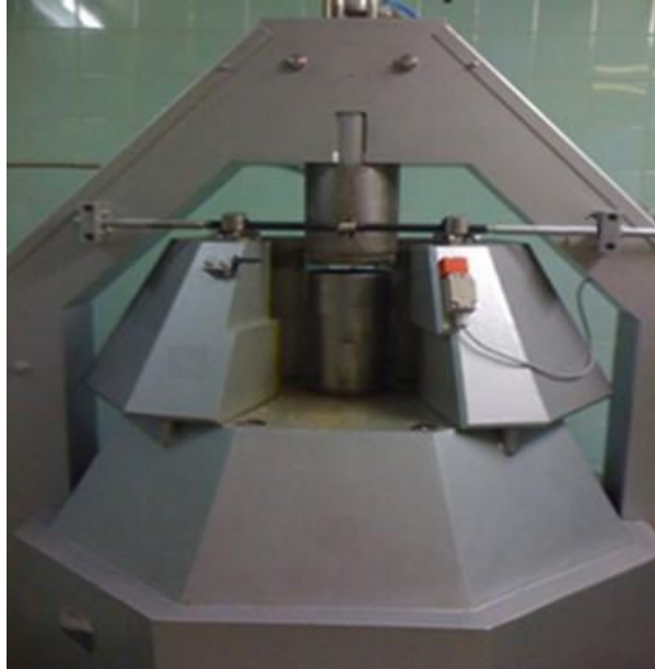
Figura B3. Montaje experimental del irradiador ISOGamma – LLCo. Centro de Aplicaciones Tecnológicas y Desarrollo Nuclear (CEADEN)
