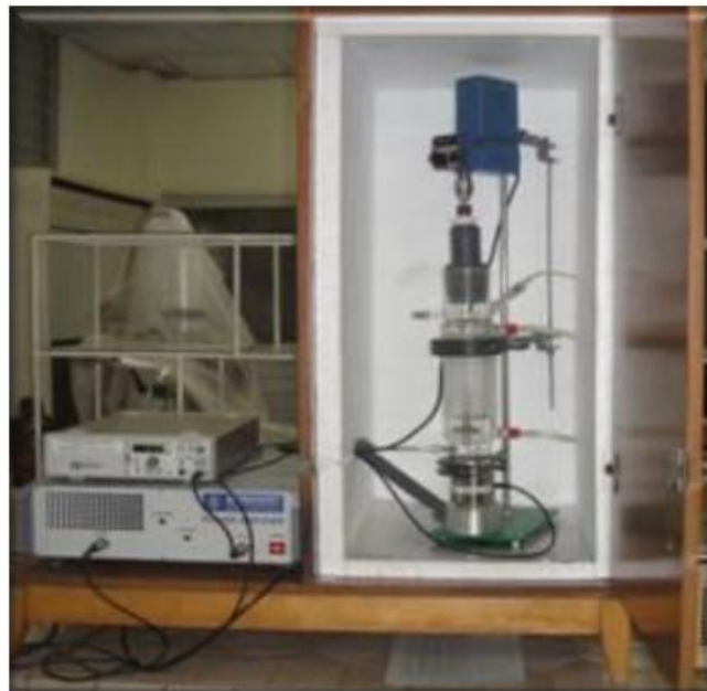
Figura B2. Montaje experimental del reactor ultrasónico. Laboratorio de Análisis Ambiental. Instituto Superior de Tecnologías y Ciencias Aplicadas (INTEC), Universidad de la Habana
