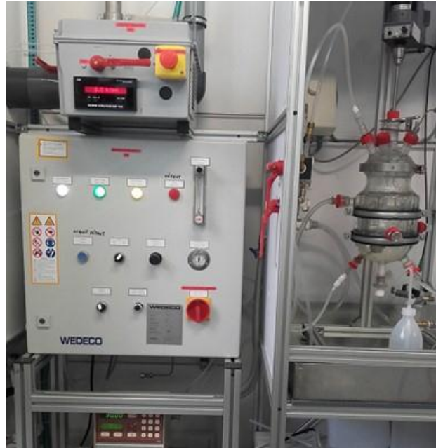
Figura B1. Montaje experimental de la ozonización. Laboratorio de Ingeniería Química, Universidad de Toulouse
