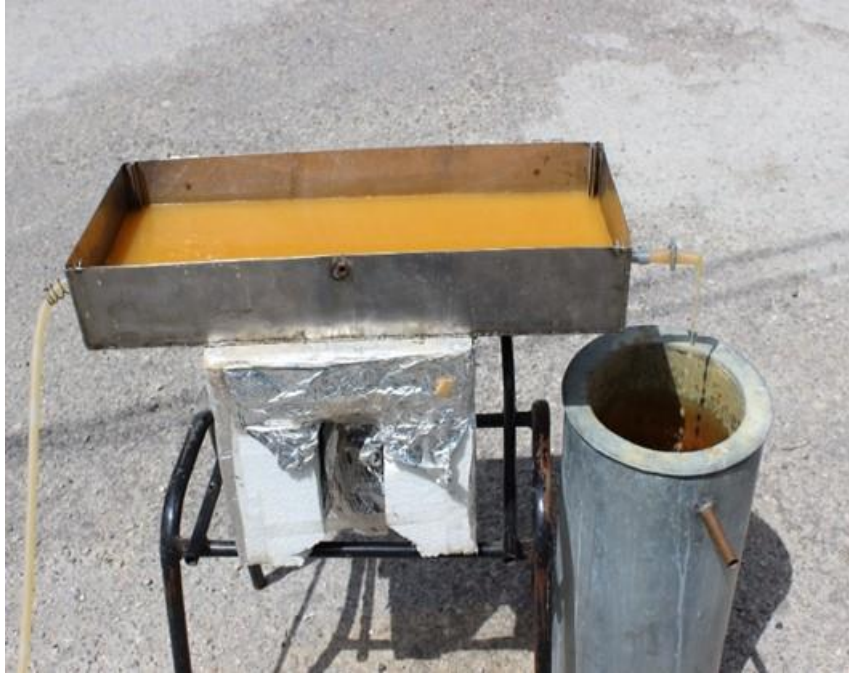
Figura B5. Montaje experimental del reactor fotoquímico a escala de banco. Laboratorio de Análisis Ambiental. Instituto Superior de Tecnologías y Ciencias Aplicadas (INTEC), Universidad de la Habana
