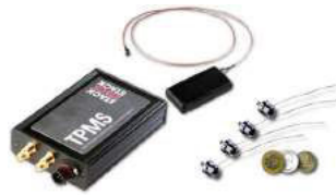
(a) Exemple d'un capteur de pression SAW
