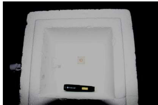
(b) Boîte isotherme avec l'antenne chargée par la thermistance et l'inductance et un capteur de température commercial
