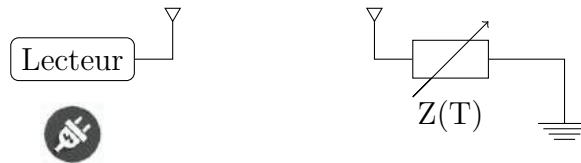
FIGURE 1.16 – Principe d'interrogation d'un capteur à transduction électromagnétique
