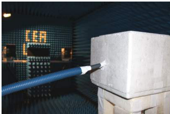
(c) Boîte contenant les capteurs dans la chambre anéchoïde
