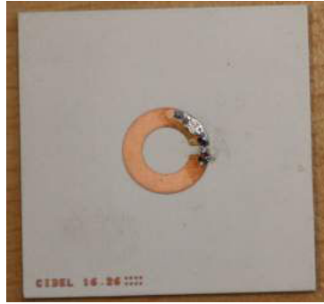
FIGURE 4.23 – Emplacement de la thermistance sur le prototype
