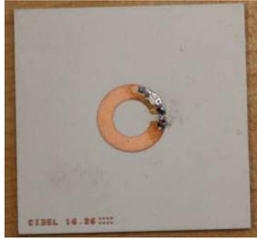
FIGURE 4.23 – Emplacement de la thermistance sur le prototype
