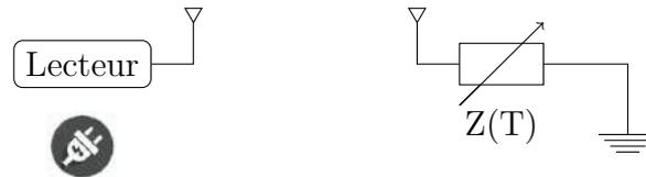
FIGURE 1.16 – Principe d'interrogation d'un capteur à transduction électromagnétique
