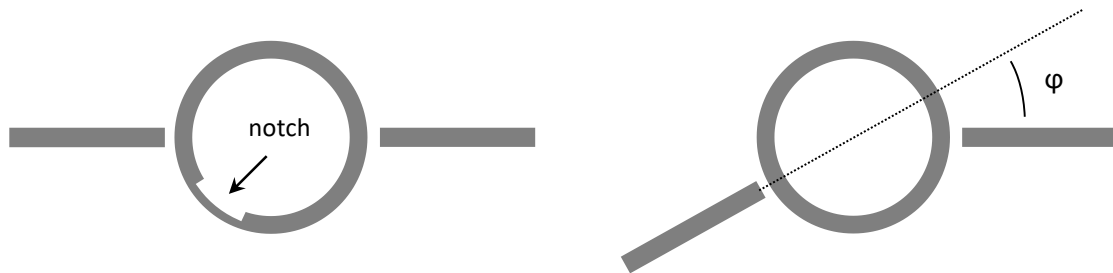
Figure II.2 Illustration des dissymétries permettant l'excitation des deux modes duaux de l'anneau.
