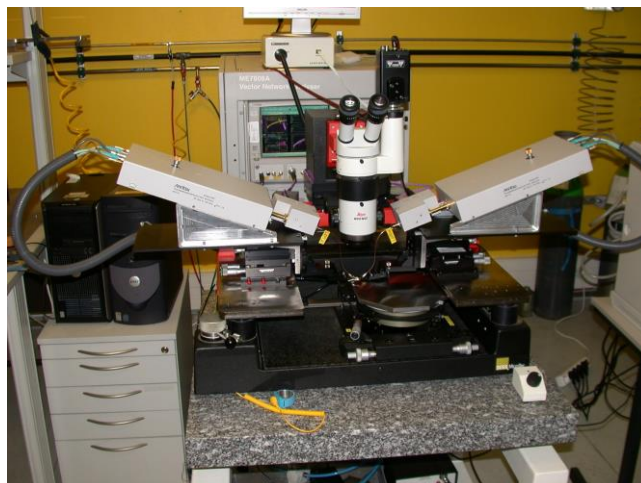
Figure III.10 Setup de mesure utilisé pour les mesures allant de 0 GHz à 110 GHz.
