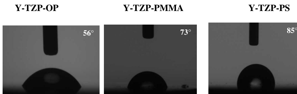
Figure 34 : Evolution de la mesure d'angle de contact à l'eau en fonction de la couche greffée sur la zircone
