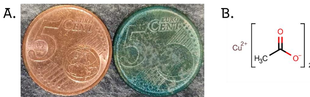
Figure 29 –A. Vert-de-gris formé sur une pièce de monnaie (acier cuivré) enveloppée pendant 3 jours dans un papier régulièrement imbibé de vinaigre de vin (pièce non-traitée en référence); B. Acétate de cuivre
