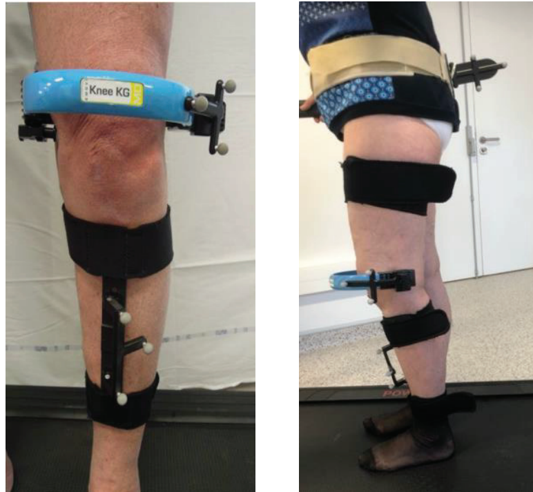
Figure 16 : Photographie d'un membre inférieur gauche montrant le bon positionnement des capteurs tibiaux et fémoraux, ainsi que le positionnement du capteur sacro-iliaque (251).
