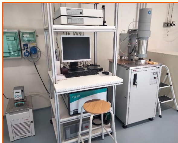
Figure 115 - LFA-427 utilisé pour la mesure de la diffusivité thermique des échantillons.
