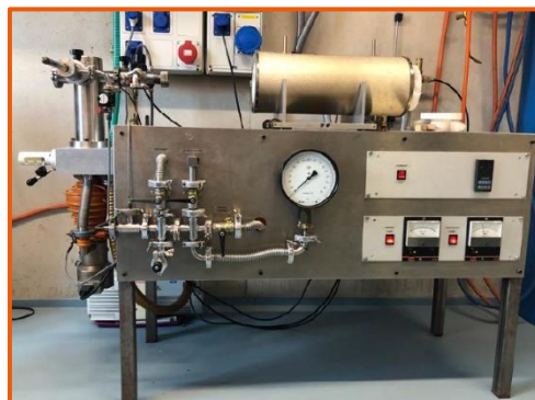
Figure 43 - Groupes de pompage primaire et secondaire utilisés pour le dégazage, le graphitage et le scellage des tubes.
