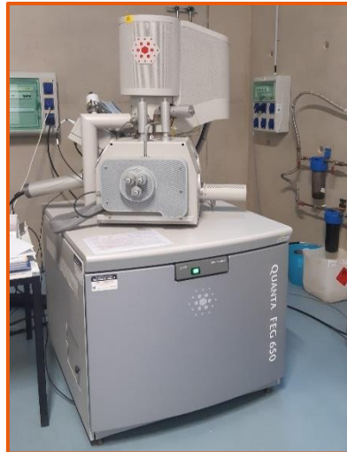
Figure 108 - Photographie du microscope électronique à balayage de l'Institut Jean Lamour.
