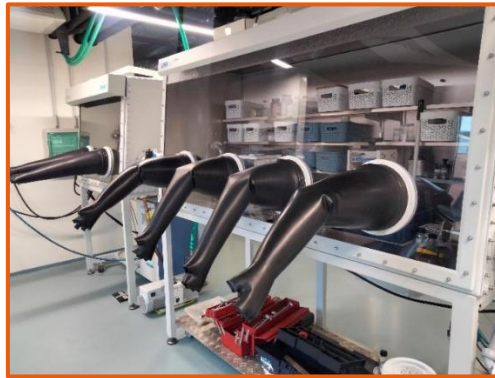
Figure 42 - Photographie de la boîte à gants utilisée pour le stockage des éléments chimiques et pour les pesées.
