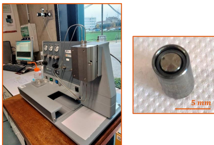
Figure 116 – A gauche, machine DSC. A droite, matrice en acier scellée avec un joint en nickel.
