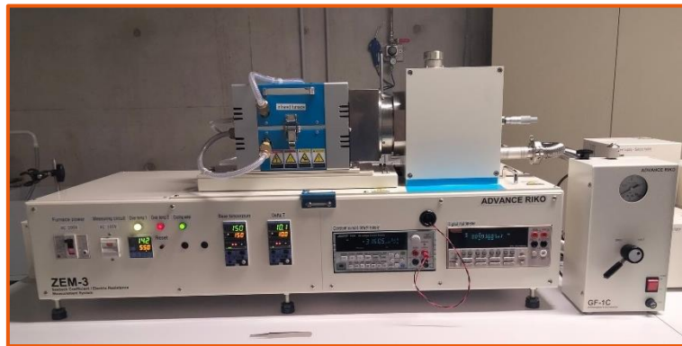
Figure 113 - Appareil ZEM-3 servant à la mesure des propriétés de transport électrique au-delà de 300 K.
