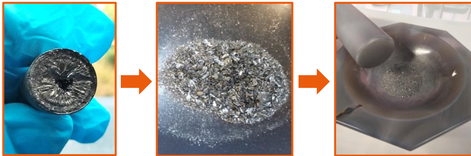
Figure 45 - Lingot de kawazulite après synthèse, broyage grossier et final dans un mortier en agate.
