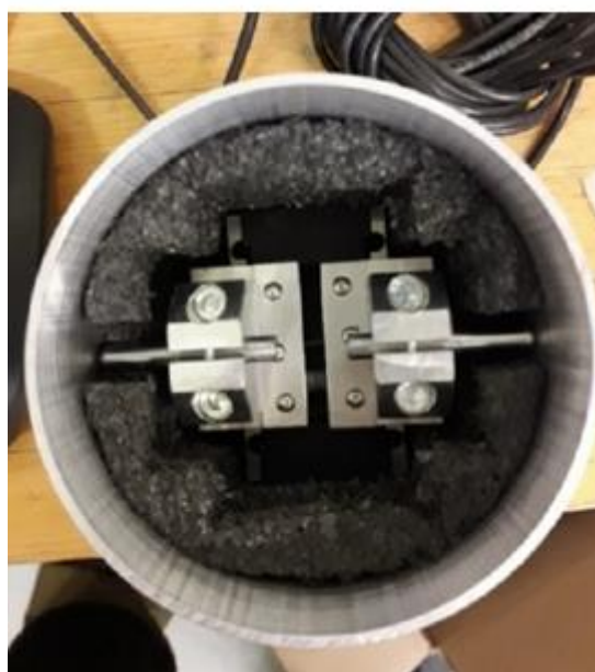
Figure 3-14 Photographie d'un capteur de déplacement interne installé dans la conduite
