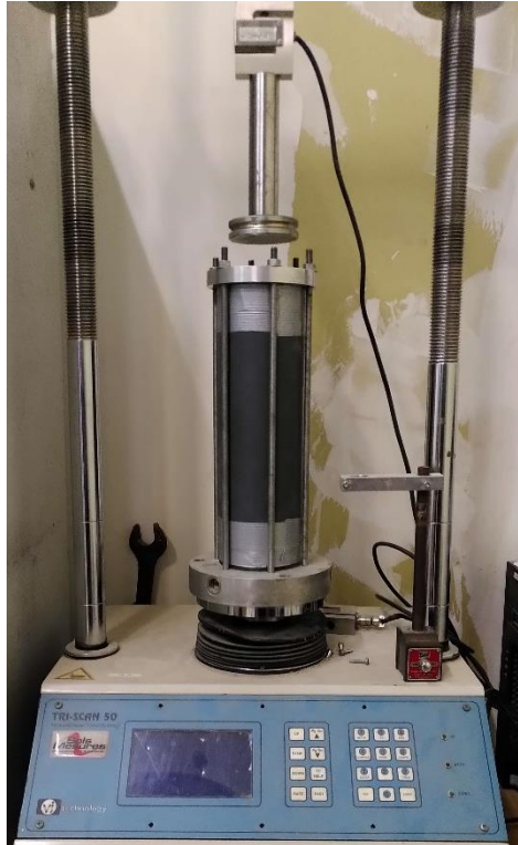
Figure 4-7 Cellule d'étalonnage des capteurs de pression totale
