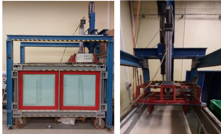
Figure 3-1 Vue de côté de la VisuCuve (gauche) et vérin de chargement (droite)
