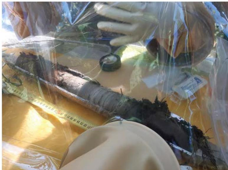
*Figure 15 : Carotte de sol de 50cm prélevée en septembre 2020 dans la zone humide à l'aval de l'ancien site minier de Rophin à l'aide d'un carottier russe placé directement dans une boîte à gants portable sous atmosphère d'azote (Crédit : Mireille Del Nero, IPHC).*
