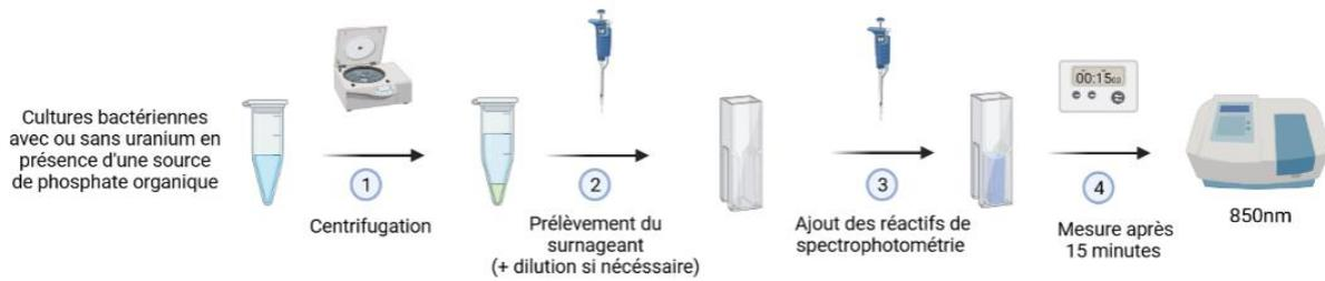
Figure 25 : Schéma du protocole pour la préparation des échantillons pour la mesure des ions orthophosphate inorganique par spectrophotométrie
