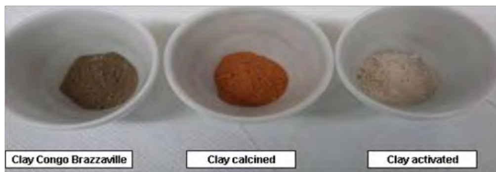
Figure 8: Argile naturelle du Congo Brazzaville et changement de couleur après traitement
