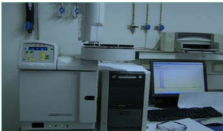
Figure II.6 : Photo de l'appareil Varian de chromatographie en phase gazeux
