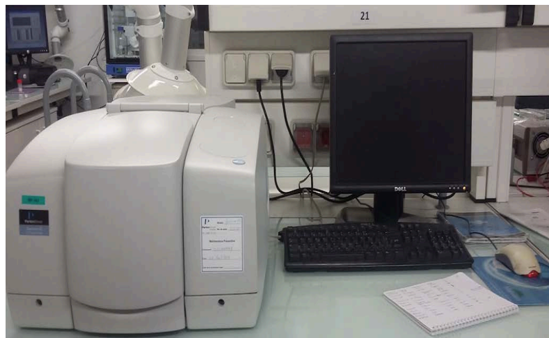
Figure II.7 : Photo du spectrophotomètre Perkin-Elmer IR-TF (Infrarouge à transformé de Fourier)
