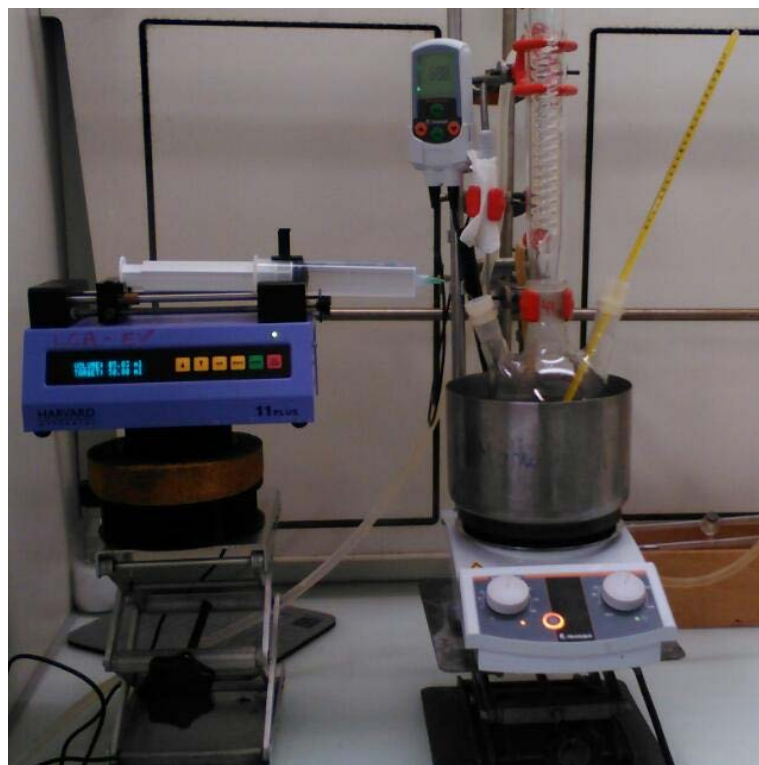
Figure II.5 : Photo réacteur de la réaction d'oxydation allylique des acides gras insaturés libres
