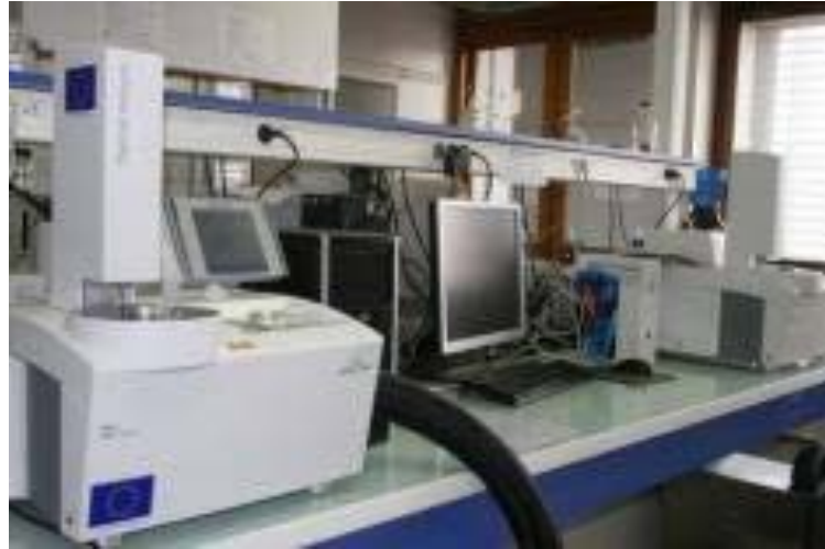
Figure II.9 : Photo d'un diffractomètre PANalytical X'Pert Pro \theta / \theta
