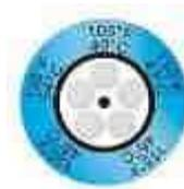
Figure IV-21 : Exemple d'une pastille thermosensible Clock 5 températures Thermax à 40, 43, 46, 49 et 54 °C.
