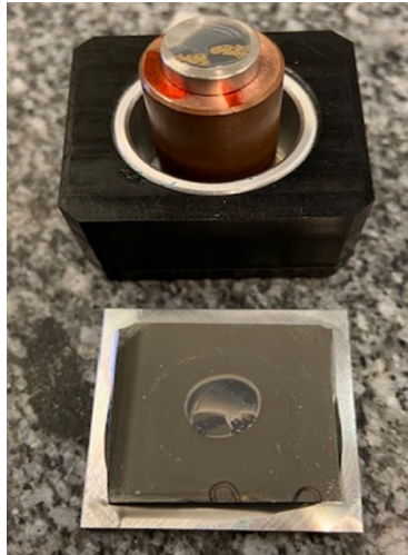
FIGURE 3.16 – Photo échantillon #2.14 (NiCr/Au(Evap.)/Si) après mesure par centrifugeuse.
