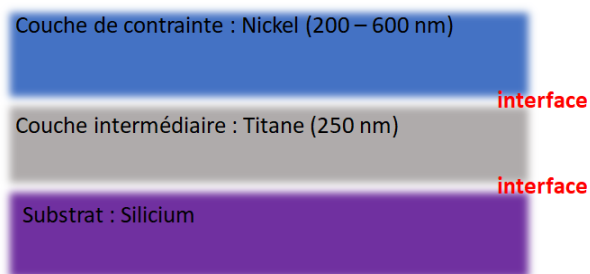
FIGURE 5.1 – Schéma d'un empilement Ni/Ti/Si.
