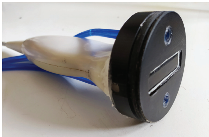
Figure 2-11. Maquette ultrasonore du projet CHORUS. Le transducteur comportant les caractéristiques des barrettes d'imagerie du futur prototype transœsophagien a été intégré au sein d'un boîtier de sonde extracorporelle. Un support noir est fixé au niveau de la tête de sonde et une ouverture permet une fenêtre acoustique pour la partie active. Deux tubulures sont insérées dans ce support et permettent de remplir une couche d'eau en regard de la sonde. Cette couche d'eau est enfermée par une membrane dont l'étanchéité est permise par une pièce venant se visser sur le support.
