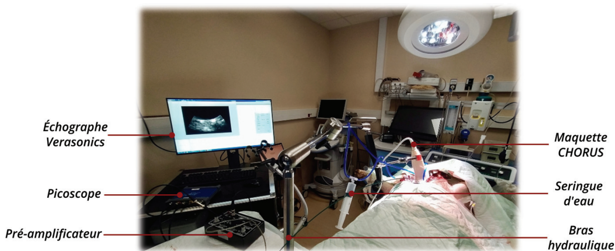
Figure 2-12. Montage expérimental in-vivo mis en place au CERMEP. Le cœur d'un cochon est exposé par une sternotomie, réalisée sous anesthésie. La maquette d'imagerie CHORUS est maintenue à l'aide d'un bras hydraulique. Une seringue permet de remplir le ballonnet d'eau séparant le transducteur de la paroi cardiaque. L'échographe Verasonics permet l'acquisition de données ultrasonores à haute cadence. Le préamplificateur permet d'amplifier le signal bipolaire électrique local au niveau de la paroi imagée, nécessaire au déclenchement de l'acquisition et enregistré à l'aide du Picoscope.
