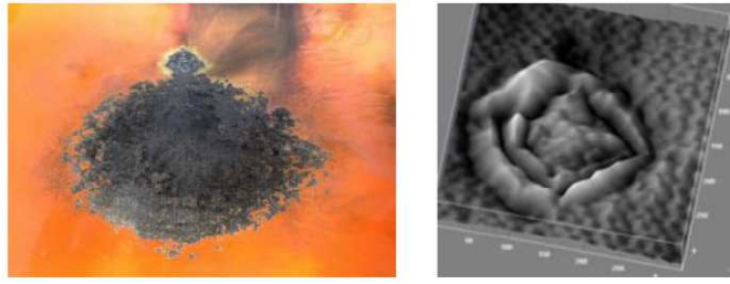
Figure 1.13 : Impact de la foudre sur un matériau composite en fibre de carbone [Tri15]
