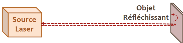
Figure 2.6 : Schéma du principe de la rétro-injection optique
