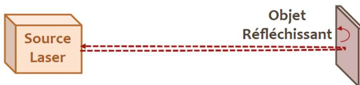
*Figure 2.6 : Schéma du principe de la rétro-injection optique*
