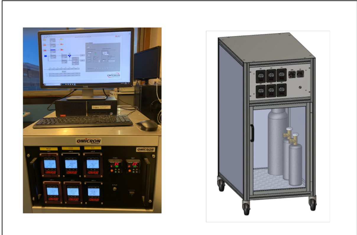
Figure 2.18: Le banc de génération/dilution de gaz ainsi que l'armoire gaz.
