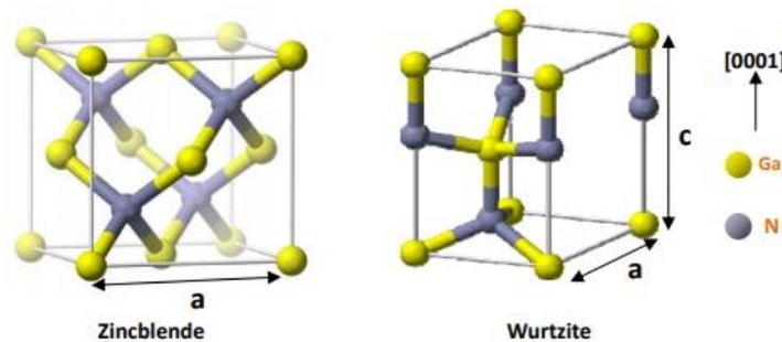
Figure 1.2 : Polytypes zinc blende et Wurtzite GaN [6].
