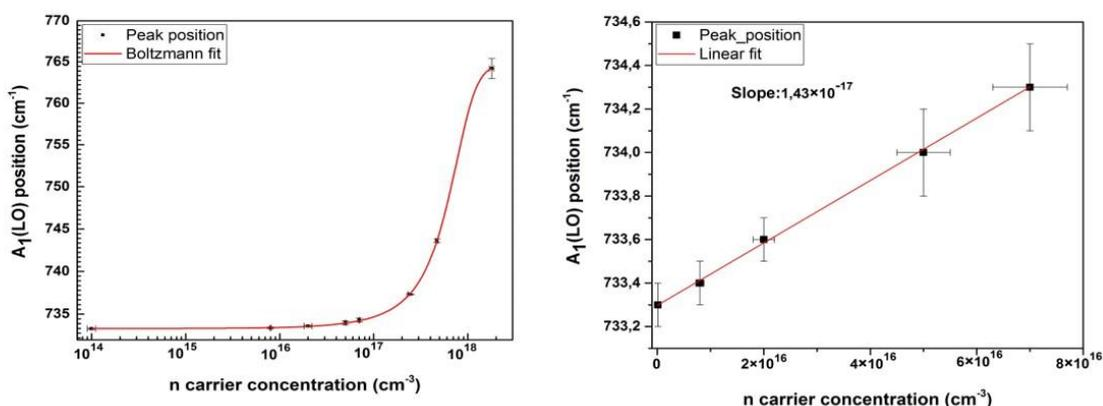
Figure 5.5 : Étalonnage de la position  $A_1(\text{LO})$  en fonction de la concentration de dopage  $n$  en échelle logarithmique (Gauche). Zoom dans la région de dopage léger  $n < 10^{17} \text{ cm}^{-3}$  avec un ajustement d'approximation linéaire. Les barres d'erreur de la concentration de porteur ont été définies sur la base de 10 % de la concentration initiale de Si pour chaque échantillon (Droite).
