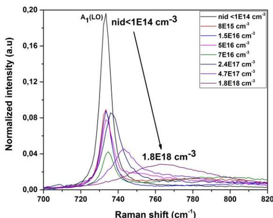
Figure 5.2 : Evolution de la position du pic  $A_1(\text{LO})$  en fonction de la densité effective de porteurs  $n$ .
