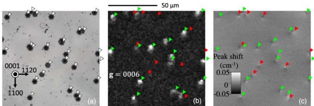
Figure 2.4 : (Couleur en ligne) Images de zone de  $100 \times 100 \mu\text{m}^2$  de (a) fosses de gravure, (b) topographie aux rayons X prise le long du  $g = 0006$  et (c) cartographie Raman du décalage de crête E<sub>2</sub> (élevé). L'emplacement de la fosse de gravure est illustré par des triangles blancs en pointillés. Les triangles rouges et verts correspondent respectivement au TED et au TMD.
