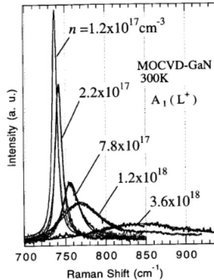
Figure 2.3 : Évolution du mode LOPC en fonction de la concentration en porteurs.
