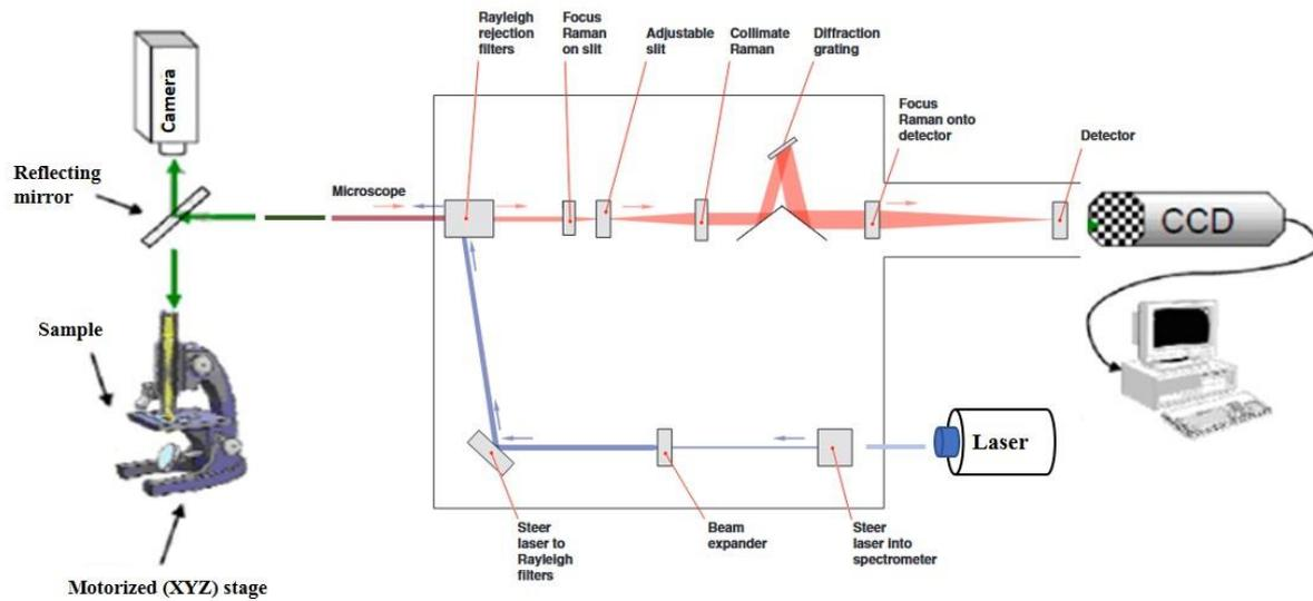
Figure.2.2 : Vue schématique de Raman Instrumentation.
