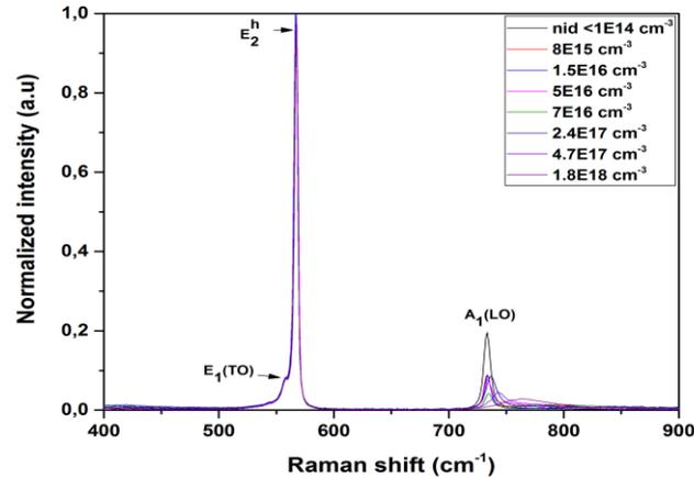
Figure 5.1 : Spectres Raman des couches épitaxiées dopées au Si. La couche nid est la couche non dopée intentionnellement. Les modes  $A_1(LO)$  changent clairement avec la concentration de porteur de type-n.
