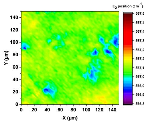
Figure 4.2 : Exemple de cartographie de position du mode  $E_2^h$  d'un substrat. Les points bleus peuvent être des dislocations pendant la croissance du substrat.
