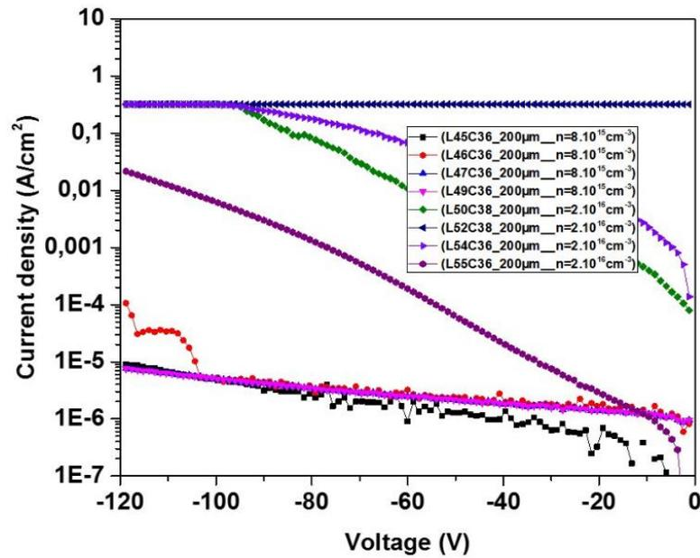
Figure 7.6 : tracé semi-logarithmique de la densité de courant inverse des diodes (200 $\mu\text{m}$ ) lorsque la concentration de porteurs augmente.
