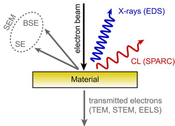
Figure. 2.3 : Analyse des matériaux basée sur le faisceau d'électrons incident.
