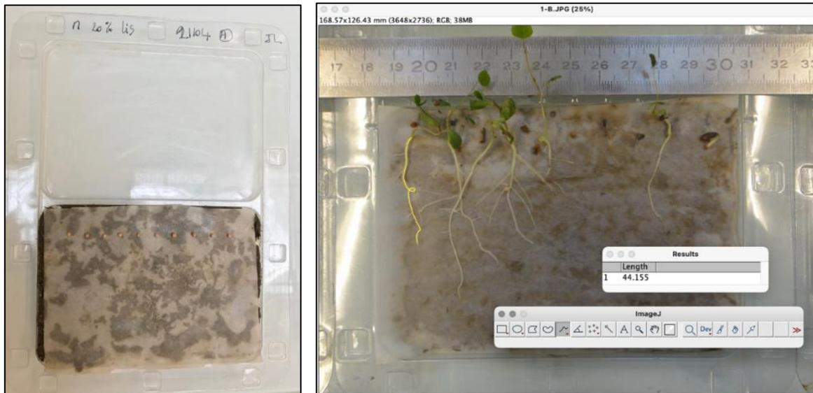
**Figure 22.** Photographie du Phytotoxkit© utilisé lors des tests de germination (© Roques Olivier).
