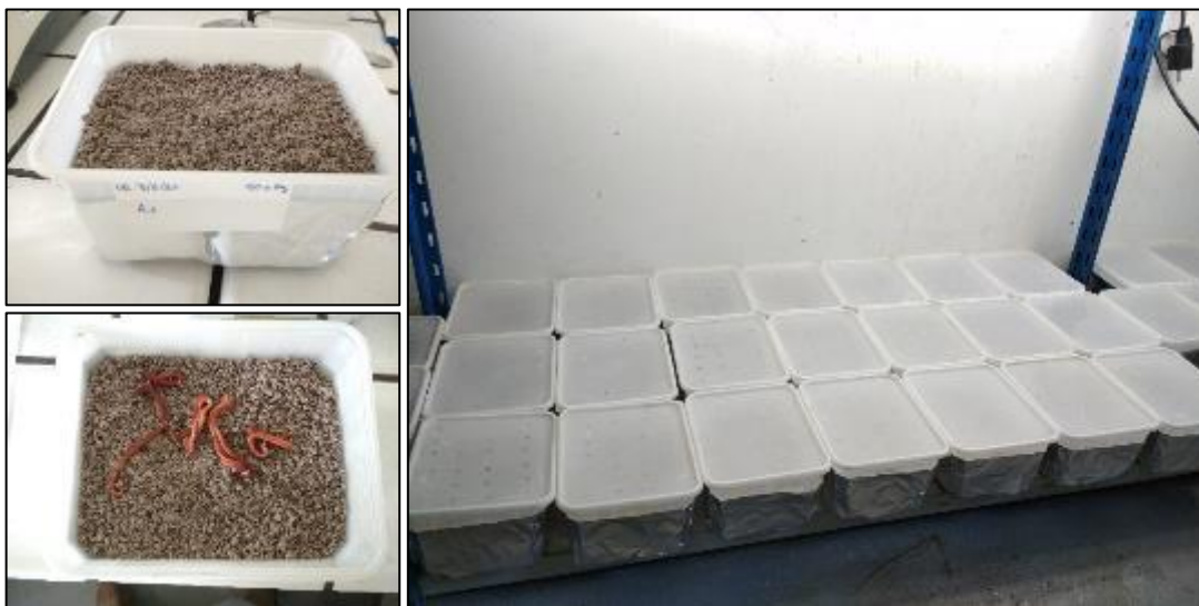
Figure 27. Dispositif expérimental recommandé par la norme ISO 11268-2 : 2015 (ISO, 2015a) et utilisé lors de l'essai préliminaire sur le test de reproduction des vers de terre Eisenia fetida exposés à différentes conditions d'exposition (© Roques Olivier).
