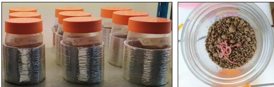
Figure 23. Dispositif expérimental utilisé lors des tests de létalité et de reproduction sur les vers de terre Eisenia fetida exposés à des sols amendés en Mafors (© Roques Olivier).
