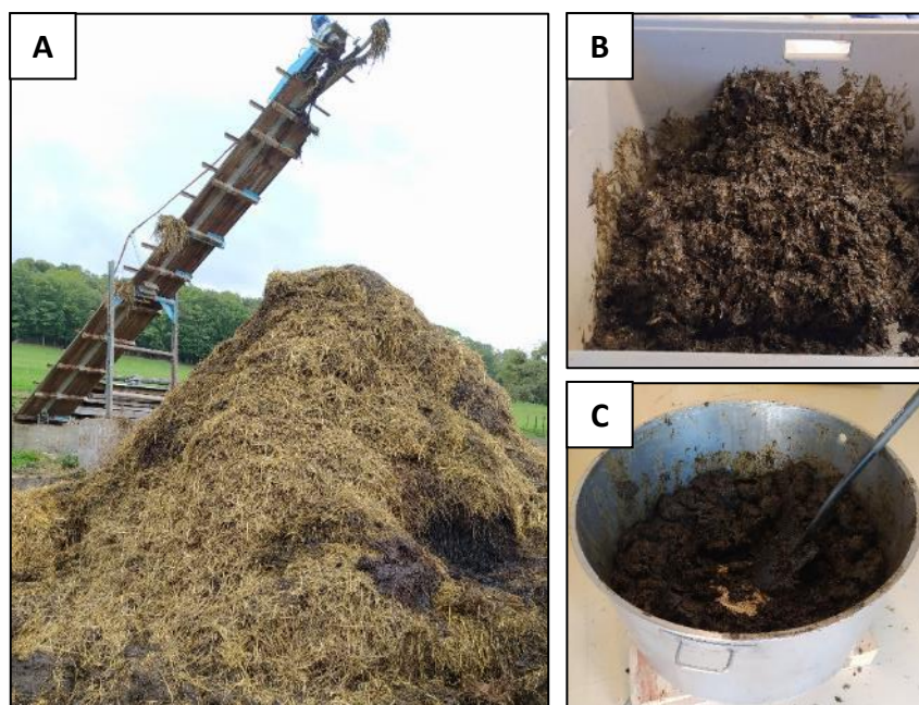
Figure 17. Tas du fumier prélevé (A), broyage du fumier dans un broyeur à cisaillement (B) et homogénéisation dans une cuve en inox (C) (© Roques Olivier).
