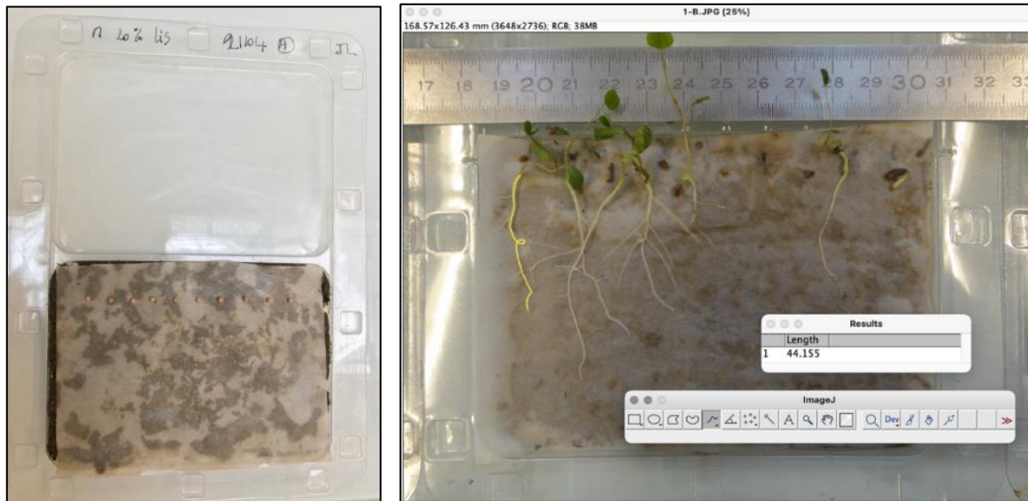
Figure 22. Photographie du Phytotoxkit© utilisé lors des tests de germination (© Roques Olivier).
