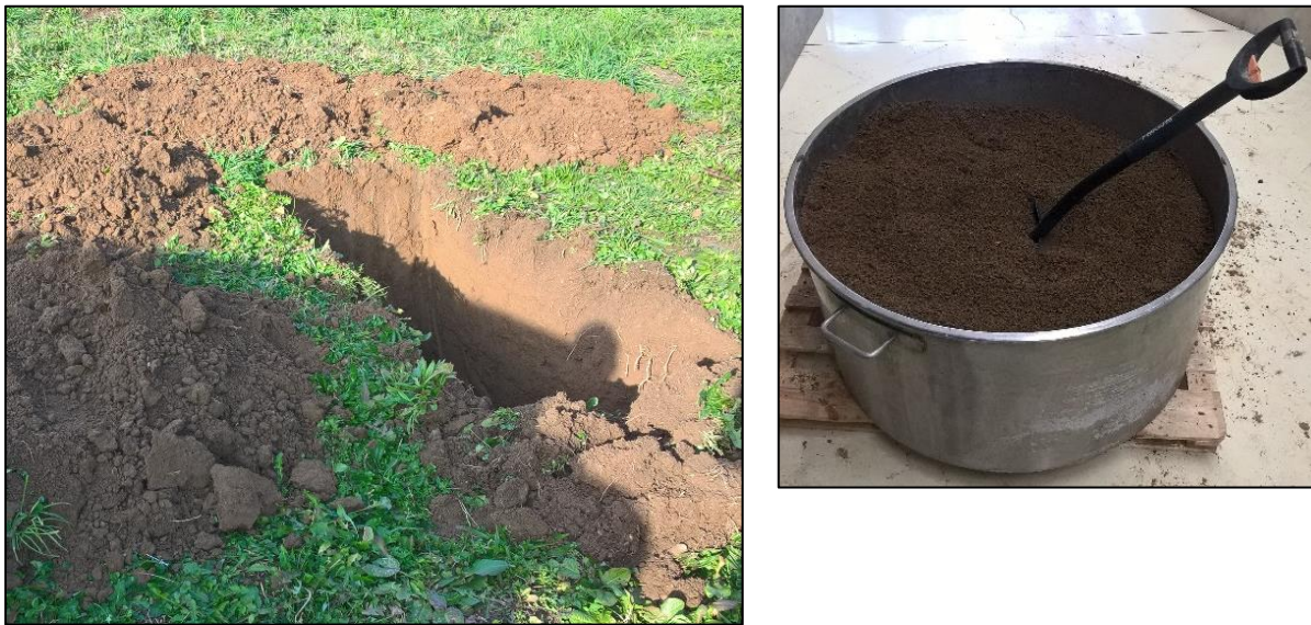
Figure 15. Site de prélèvement du sol de référence et homogénéisation manuelle dans une cuve en inox (© Roques Olivier).
