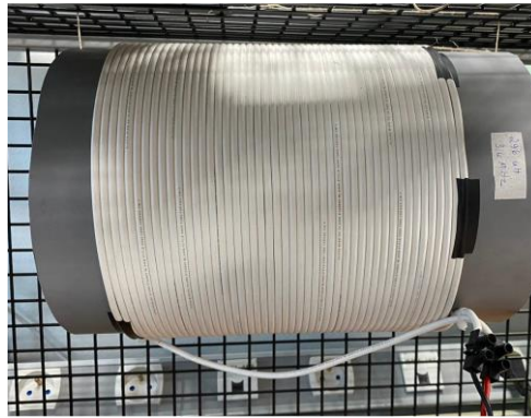
Figure 93 : Solénoïde simple couche à air.
