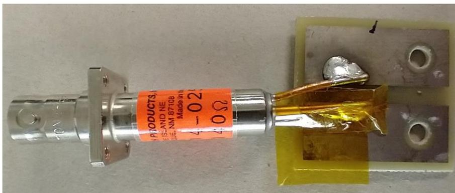
**Figure 91 : Shunt pour mesure de  $I_{AK}$  du DUT.**
