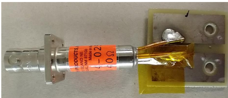
Figure 91 : Shunt pour mesure de I_{AK} du DUT.
