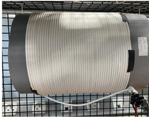
**Figure 93 : Solénoïde simple couche à air.**
