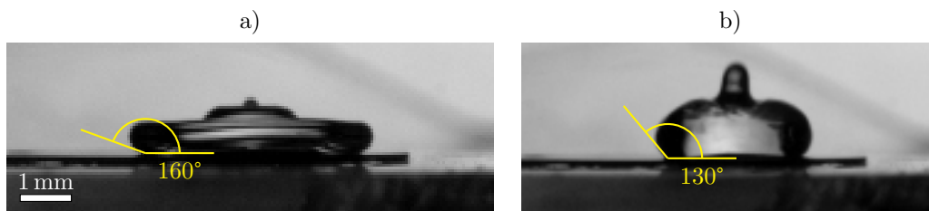
FIGURE 4.3 – Mesure de l'angle de contact lors de l'impact d'une goutte sur une membrane fabriquée (vitesse d'impact U = 0.7 \text{ m s}^{-1} ). a) Mesure de l'angle d'avancée. b) Mesure de l'angle de reculée.
