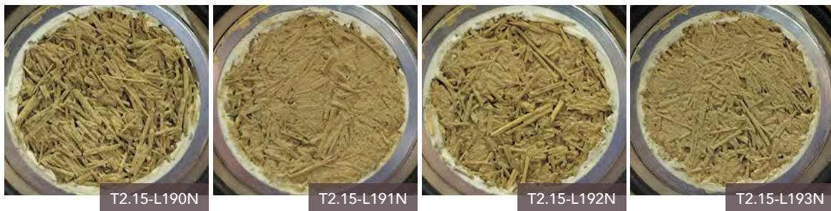
Figure 124 Comparaison de l'aspect de surface des éprouvettes d'un même mélange. Terre 2 – 15%Lin.
