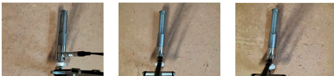
Figure 323 Mesures in situ du coefficient d'absorption acoustique par fréquence et photographies de la mesure. Enduit terre sur bottes de paille – Mouais.
