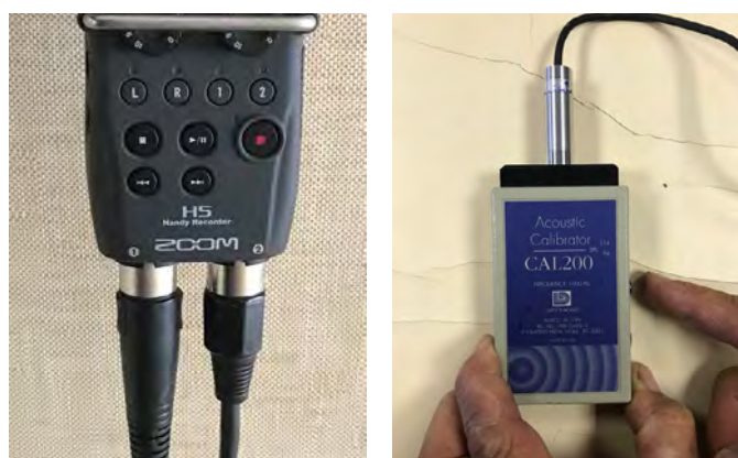
Figure 355 Branchement des micros (à gauche) et calibre (à droite).
