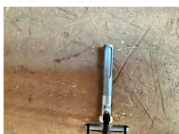
Figure 308 Mesures in situ du coefficient d'absorption acoustique par fréquence et photographies de la mesure. Mur en bauge (partie basse) – Bouvron.
