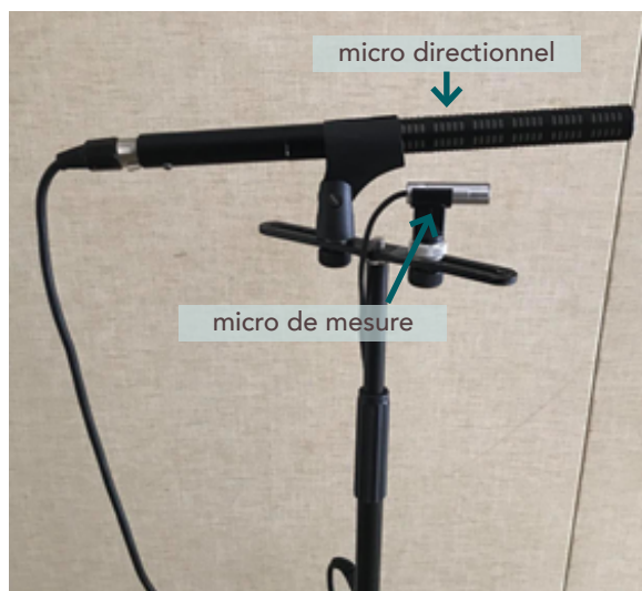
Figure 357 Positionnement des deux microphones des mesures.
