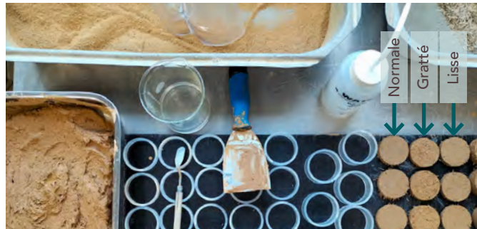
Figure 118 Exemple de réalisation des éprouvettes avec trois finitions différentes.
