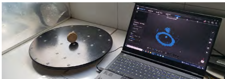
Figure 51 Calcul du volume par Scanner 3D Hybride Shining 3D Einscan HX.
