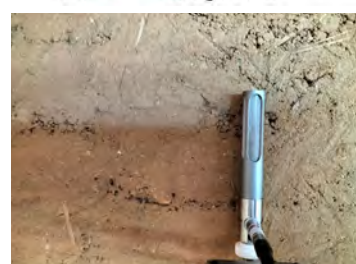
Figure 308 Mesures in situ du coefficient d'absorption acoustique par fréquence et photographies de la mesure. Mur en bauge (partie basse) – Bouvron.
