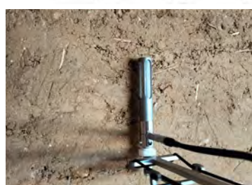
Figure 308 Mesures in situ du coefficient d'absorption acoustique par fréquence et photographies de la mesure. Mur en bauge (partie basse) – Bouvron.
