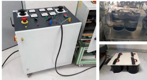
Figure 4.3 : Source de tension et capacités de filtrage
