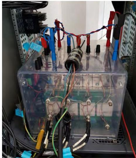
Figure 4.4 Onduleur SEMIKRON
