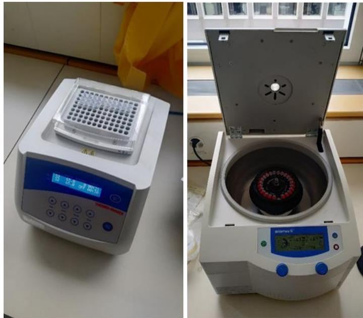
Figure 9.2 - A : Bloc chauffant ; B : Centrifugeuse
