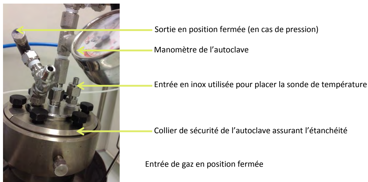
Figure 203 : Structure de l'autoclave utilisé pour des essais en conditions étanches
