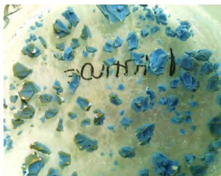
Figure 190 : Catalyseur à la sortie de l'étuve
