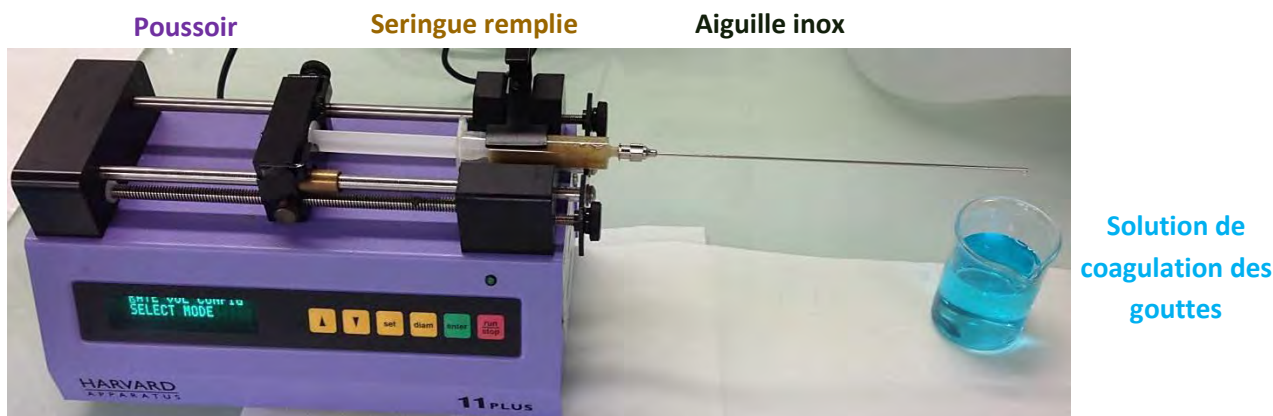
Figure 210 : Poussoir automatique avec la seringue contenant la solution d'alginate dont la sortie est située au-dessus de la solution de coagulation du gel
