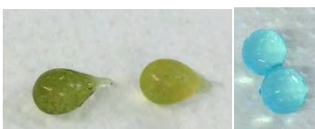
Figure 147 : Billes d'alginate avec enzymes (à gauche) et billes d'alginate vides (à droite)
