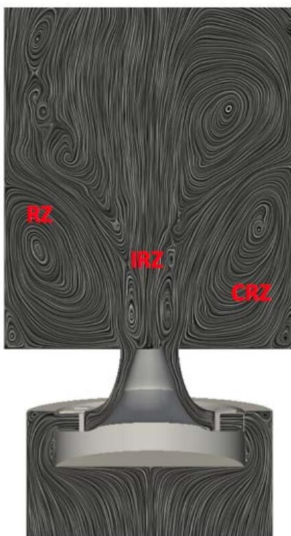
Figure 5.3 – Topologie de l'écoulement non réactif.
