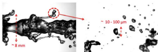
Figure 1.7 – Atomisation assistée par air : déstabilisation d'un jet liquide par un courant gazeux [196].
