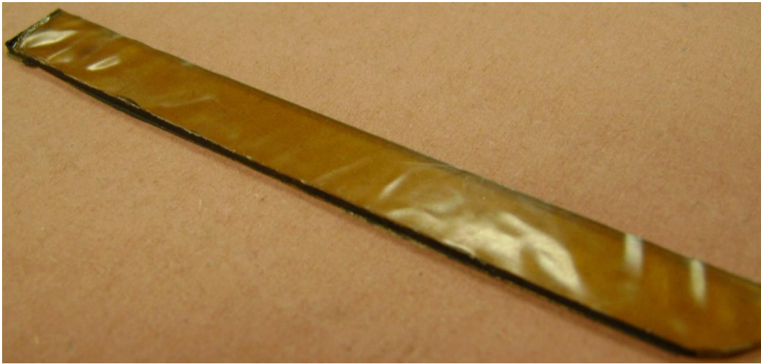
Figure 30 Présence de gondolements suite à l'amorphisation du PEKK
