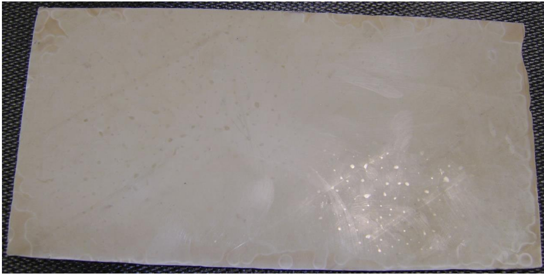
Figure 26 Plaque semi-cristalline moulée dans la presse chauffante, « traces diagonales du clinquant »
