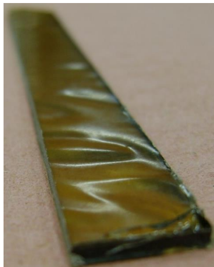
Figure 30 Présence de gondolements suite à l'amorphisation du PEKK
