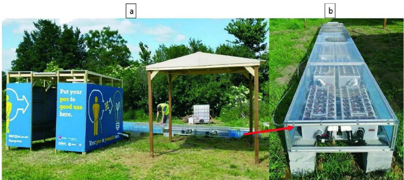
Figure 6 : Photographies (a) de toilettes publiques conçues avec un ensemble de 432 PACMs installées lors du festival de musique de Glastonbury (Juin 2015), (b) du module d'assemblage des PACMs (tirées de Ieropoulos et al., 2016).
