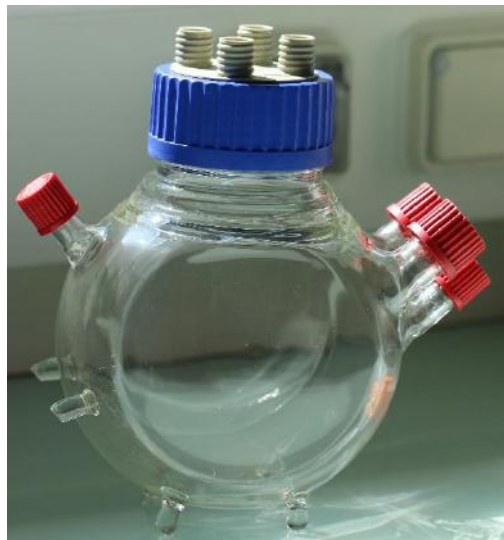
Figure 6 : Photographie du réacteur « boîte à bonbon » de 1.8 L.
