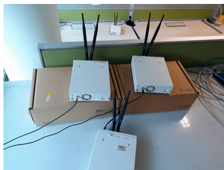
FIGURE 5.3 Banc d'essais utilisé pour le Two-Path Relaying
