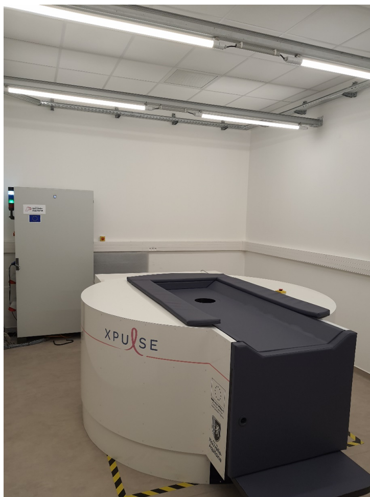
FIGURE 3.2 – Photographie de l'installation de tomographie installée à l'IBIO. Le détecteur, la source à rayons X et le plateau tournant sont situés sous le lit.
