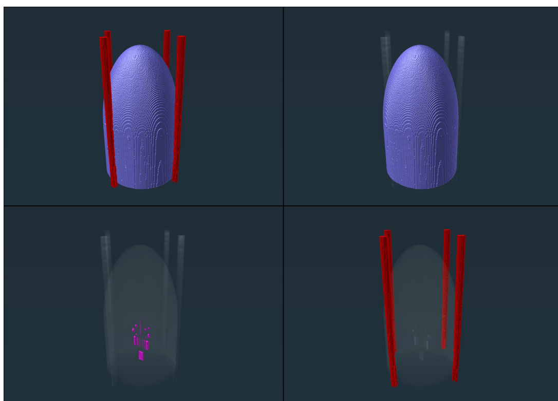
FIGURE 6.18 – Segmentation de trois matériaux du fantôme de sein. En rouge le support en bois, en bleu le plastique imprimé en 3D, et en magenta les inserts d’hydroxyapatite ( \text{Ca}_5(\text{PO}_4)_3(\text{OH}) ) et d’oxalate de calcium ( \text{CaC}_2\text{O}_4 ).
