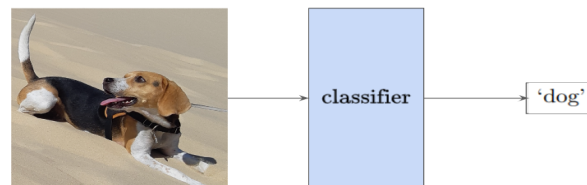
Figure 2.1 – Un classifieur permet de trier des images en catégories appelées labels . Le classifieur connaît d’abord une étape d’entraînement durant laquelle il apprend à effectuer cette répartition.
